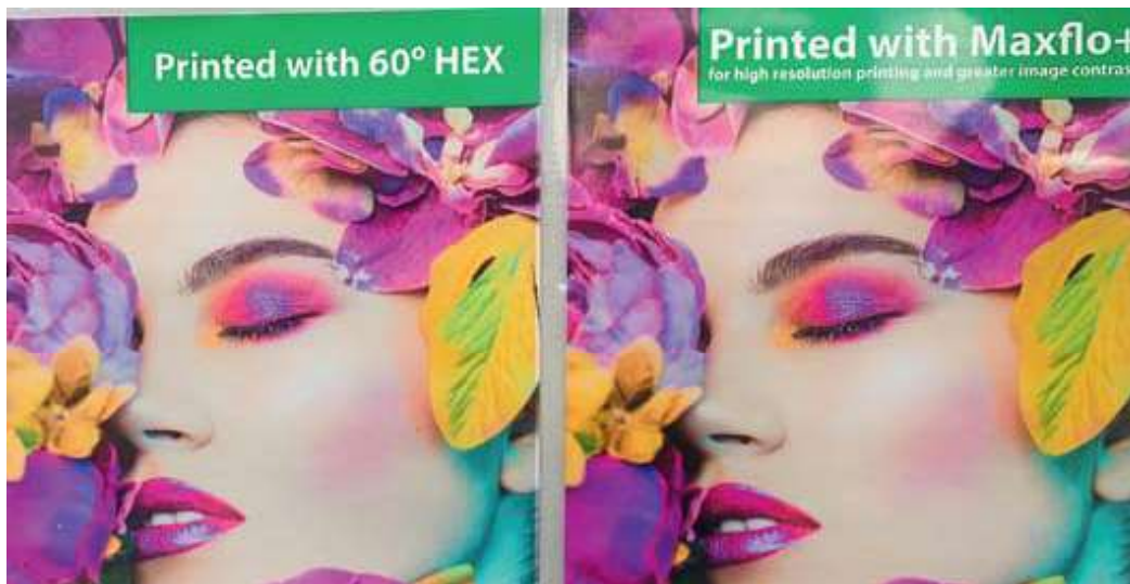
Рис. 2. Образцы, отпечатанные с анилоксов с шестигранной гравировкой 60° (слева) и гравировкой MaxFlo+ (справа)
