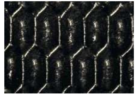
Рис. 1. Микрофотографии поверхности анилоксов с шестигранной гравировкой 60° (слева) и гравировкой MaxFlo+ (справа)
